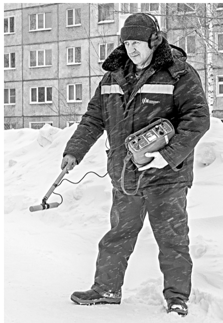
■ С помощью трассоискателя Александр Сантьев слушает подаваемые на кабельную линию сигналы, проводя таким образом диагностику подземных инженерных коммуникаций.
